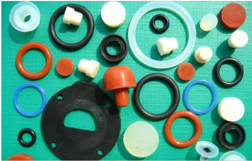
1. 橡胶制品的主要原料是以生胶为基本材料，而生胶就是生长在热带，亚热带的橡胶树上通过人工割开树皮收集而来。2. 各种配合剂，是为了改善橡胶制品的某些性能而加入的辅助材料。3. 纤维材料有（棉、麻、毛及各种人造纤维、合成纤维和金属材料、钢丝）是作为橡胶制品的骨架材料，以增强机械强度、限制制品变型。在原材料准备过程中配料必须按照配方称量准确。为了使生胶和配合剂能相互均匀混合，需要对材料进行加工。生胶要在60--70℃烘房内烘软后再切胶、破胶成小块，配合剂有块状的。如石蜡、硬脂酸、松香等要粉碎。粉状的若含有机械杂质或粗粒时需要筛选除去液态的如松焦油、古马隆需要加热、熔化、蒸发水分、过滤杂质，配合剂要进行干燥不然容易结块、混炼时若不能分散均匀硫化时产生气泡会影响产品质量。
